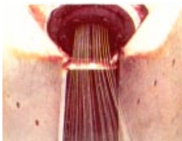
В промышленности волокна получают, продавливая полимер через фильеры
